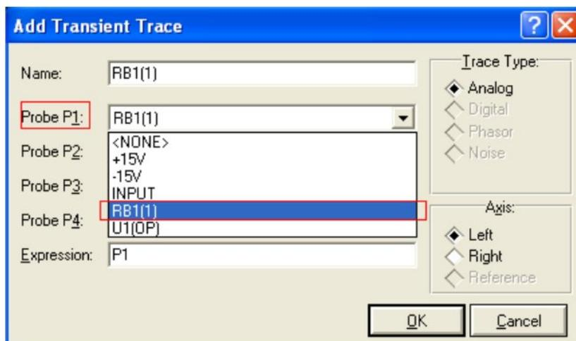
از منوی graph گزینه ی simulate graph را انتخاب کنید میبینید که شکل موج ورودی به نمایش در می آید ، در صورتی که مایل به نمایش شکل موج های دیگر در کنار این شکل موج هستید ، از منوی Graph گزینه ی ADD Trace را انتخاب کنید و شکل موج دیگری را نیز اضافه کنید ، توجه داشته باشید که پس از اعمال هر شکل موج باید بر روی ok کلیک کنید و گزینه ی simulate graph را بزیند تا شکل موج به نمایش در آید . در صورتی که این پنجره را ببینید ، شکل موج ها در داخل پنجره اصلی به نمایش در میاید:
