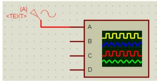
مقدار فرکانس منبع 10 هرتز و ولتاژ دامنه ان (Amplitude) 5 ولت باشد. شبیه سازی را آغاز کنید ، مشاهده میکنید که پانل
