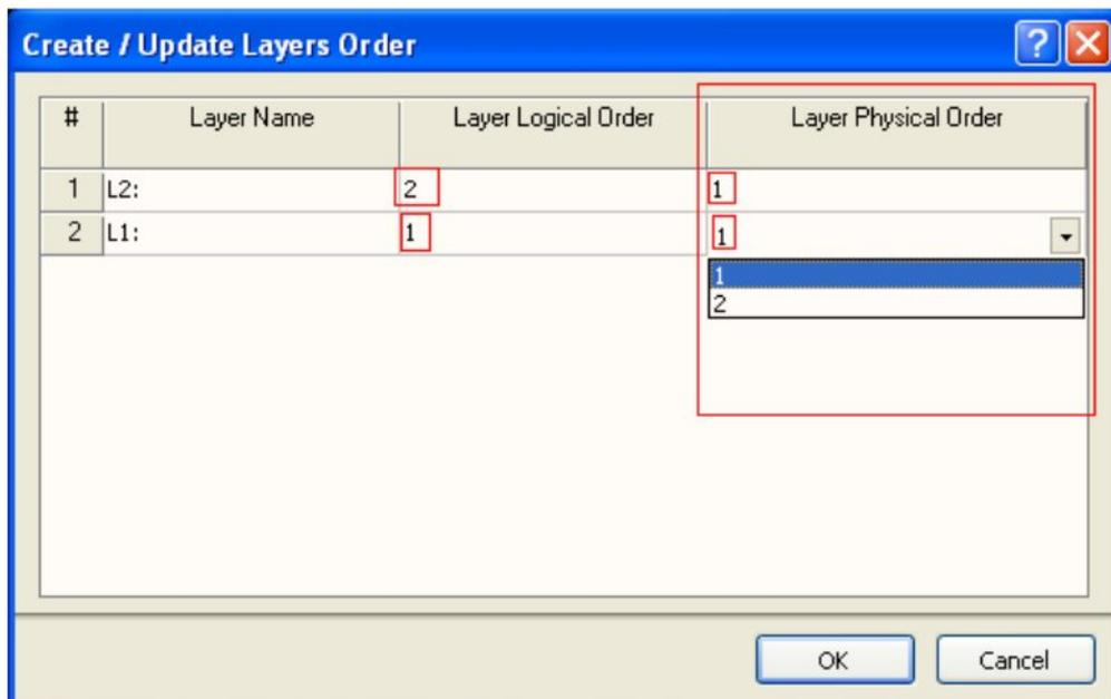
در پنجره بالا روی ok کلیک نمایید و از منوی analysis گزینه ی pcb design check/ fix را انتخاب کنید :
