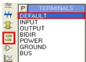
برای استفاده از این نوع ترمینال ، قطعات مورد نیاز را در مکان مناسب در صفحه شماتیک قرار دهید ، سپس در این منو بر روی DEFAULT کلیک نمایید و دوباره بر روی پایه مورد نظر کلیک کنید. این کار را برای تمامی پایه ها انجام دهید:
