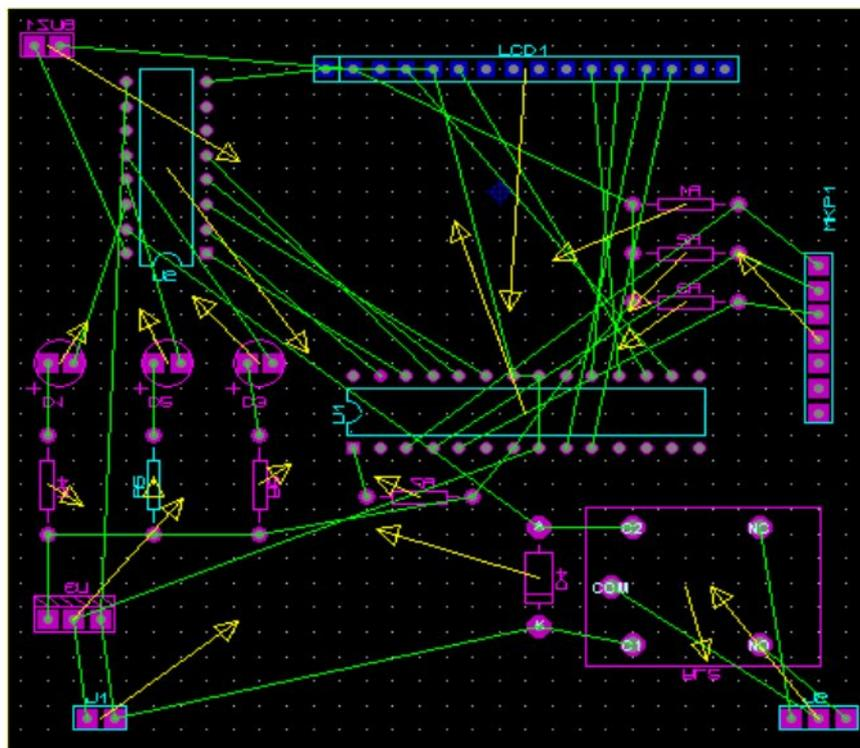
در این نرم افزار نیز مانند پروتل میتوانید از چیدمان اتوماتیک استفاده کنید ، برای این کار از منوی Tools گزینه ی Auto Placer را انتخاب کنید ، در پنجره ای که با انتخاب این گزینه باز می شود ، میتوانید معین کنید که کدام قطعات در چیدمان خود کار وجود داشته باشند و فاصله بین آنها چقدر باشد . بعد از اعمال تنظیمات روی ok کلیک کنید ، مشاهده میکنید که قطعات در کمترین فضای ممکن چیده میشوند .
