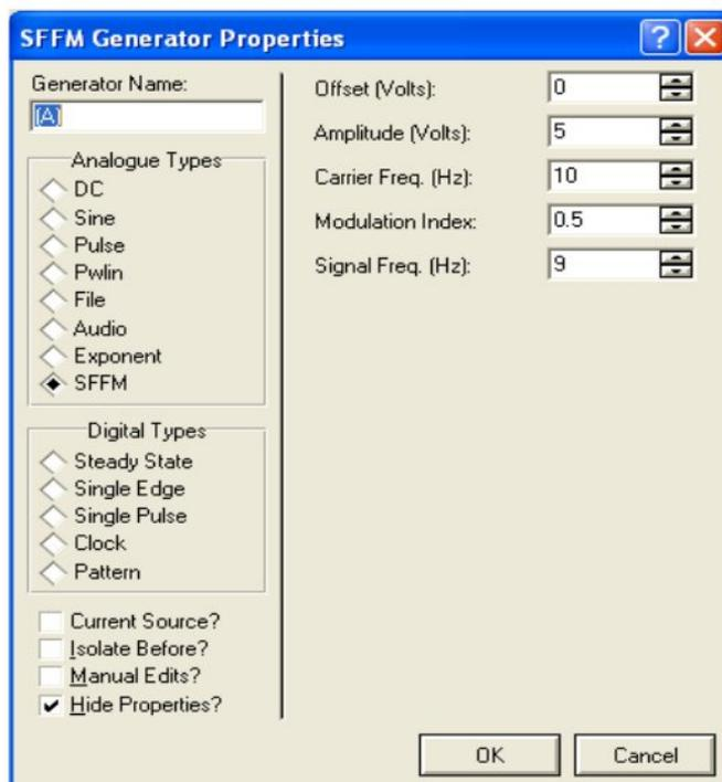
در پنجره بالا offset مقدار سطح dc اضافه شده به ولتاژ است همچنین amplitude دامنه ولتاژ هر دو شکل موج را مشخص میکند. Carrer , single freq نیز فرکانس سیگنال اصلی و سیگنال حامل میباشد و گزینه ی modulation index مشخص کننده ضریب مدولاسیون است . برای دیدن شکل موج این منبع از اسیلوسکوپ استفاده کنید .
