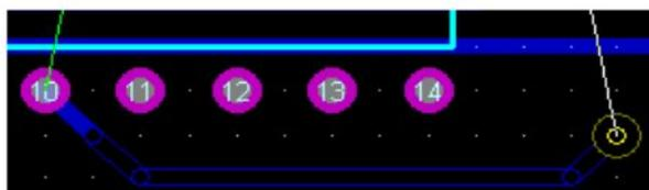
در صورتی که مسیری جلو شماست در یک مکان مناسب (منظور از مکان مناسب جایی است که در مسیر جامپر قطعه یا چیزی نباشد ، همچنین پایه جامپر به خطوط دیگر برخورد نکند و...) دوبار کلیک راست کنید تا بتوانید یک جامپر بزنید :
