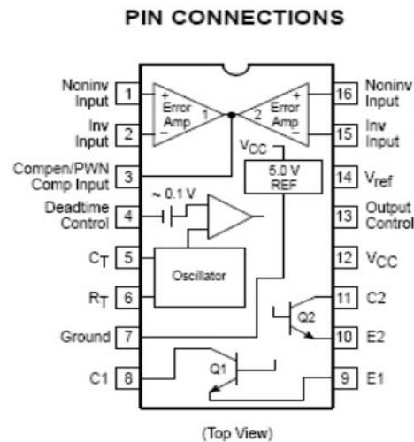
ای ایسی که در منابع تغذیه سوئیچینگ کاربرد دارد، تهیه کننده پالس pwm برای راه اندازی ترانزیستور های قدرت میباشد دیتا شیت
