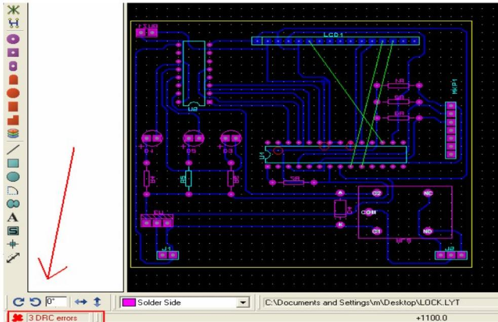
در مدار بالا چند مسیر وجود دارد که نرم افزار نمیتواند آنها را رسم کند ، برای رسم این مسیر ها باید از مسیر کشی دستی استفاده شود .
