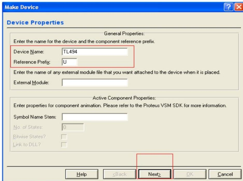
بر روی NEXT کلیک کنید ، در قسمت بعدی باید برای قطعه خود یک پکیج PCB مناسب انتخاب کنید :
