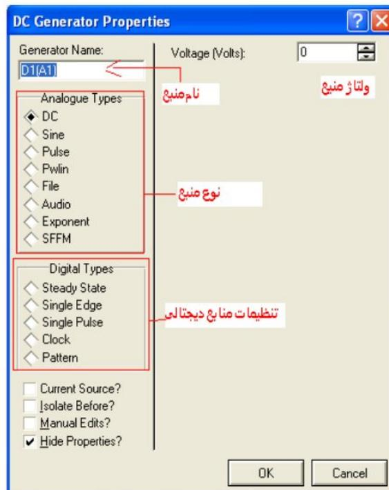
در قسمت "ولتاژ منبع"، باید ولتاژ مورد نیاز نوشته شود، در این مدار با 3 ولت برای راه اندازی led موجود نیاز داریم، بنابراین در
