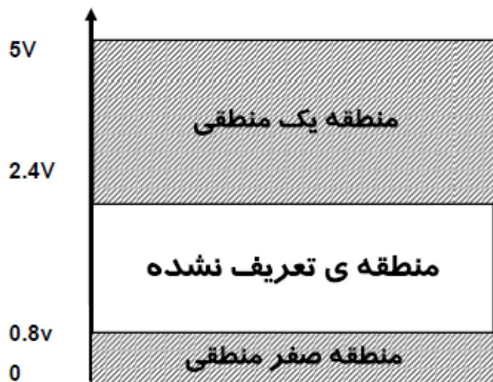
در مدارهای منطقی، صفر و یک به هیچ عنوان به مفهوم صفر و یک جبری برای نمایش داده مقدار یک شیء نیست، بلکه صفر و یک نشان دهندهٔ سطوح ولتاژ است و روشن و یا خاموش بودن یک سیستم نیست، بدین معنا که ولتاژ 0 ولت (عملای از 0 تا 0.8 ولت) به منزلهٔ صفر منطقی و ولتاژ 5 ولت (عملای از 2.4 تا 5 ولت) به منزلهٔ یک منطقی در نظر گرفته می‌شود.
